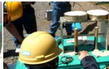
採取泡沫試料進行發泡性能測試
