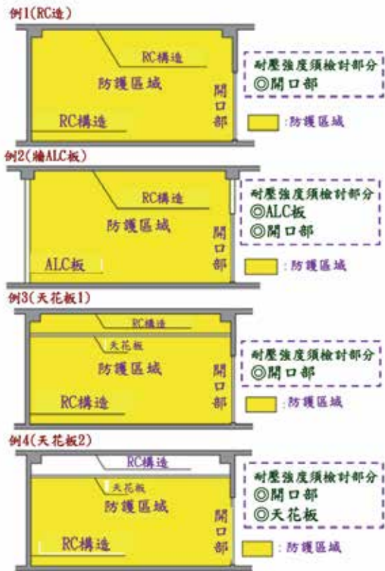
圖 16 耐壓強度須檢討部分
