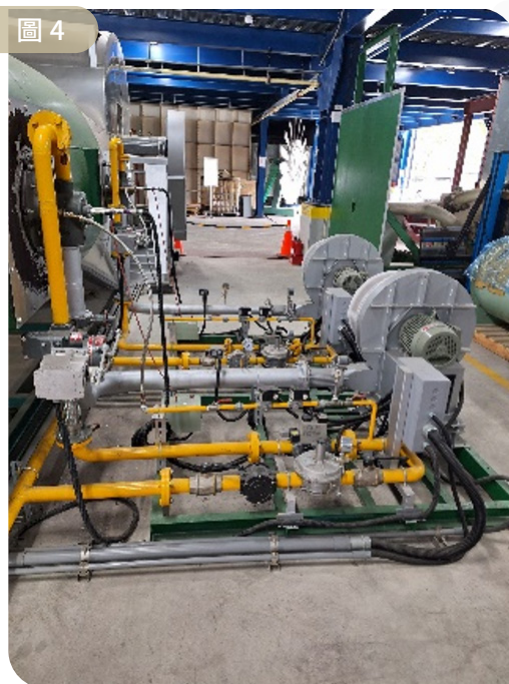
排煙閘門加熱試驗系統（由陽鼎實業股份有限公司專業提供）
