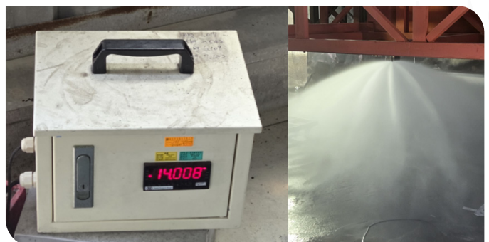
14\text{ kgf/cm}^2 迴水板強度試驗
