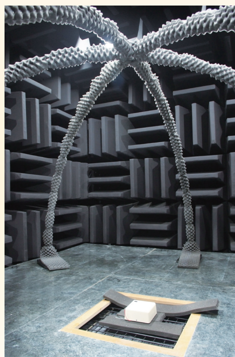
■ 無響室檢測設備。
