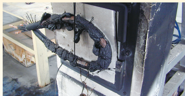
■耐熱電線電纜—耐熱試驗。
