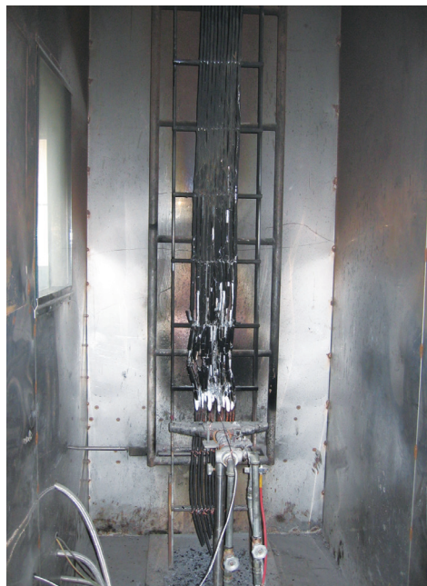
■耐熱電線電纜多條電線垂直燃燒試驗。
